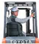
サスペンション付ORS回転シート(オプション)とホーン付リヤビラーアシストグリップで後進時の視野を拡大。安心走行に貢献。
