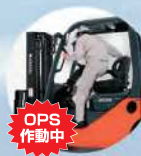
※目立、ブレーキがかかるだけでは抑止せず、降車時にはバッキングブレーキの操作が必要です。
